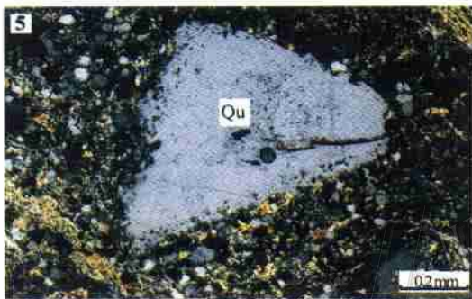
照片5 钠长石英斑岩中呈次生加大、碎屑(晶屑)状的石英变斑晶(Qu)。正交(T4)
