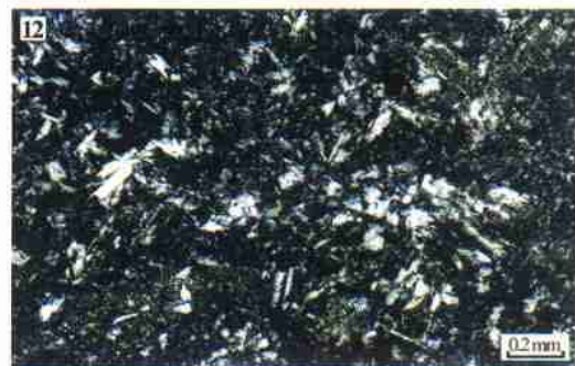
照片 12 安山玢岩,由自形、半自形板状中长石及粒状石英、绢云母、绿泥石微晶交织形成(交织结构)。正交(T10)
