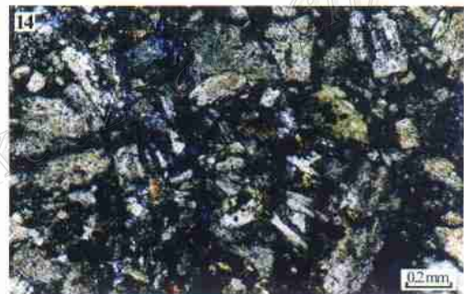
照片 14 主要由自形、半自形板状斜长石(拉长石)交织而成的高铝玄武岩。正交(T33)
