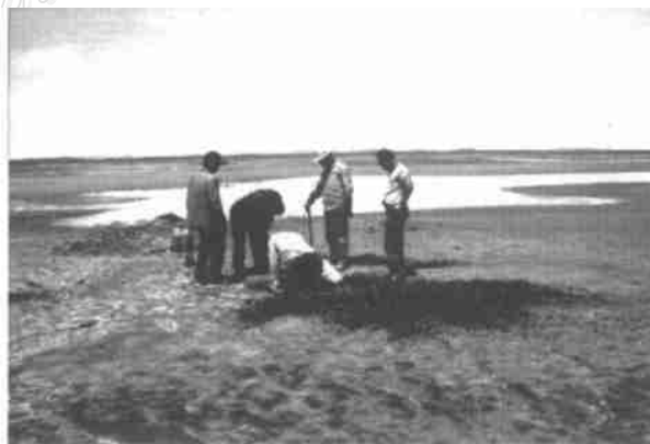
图版 6 铁南凹地中的细砂质“潮湿地”,课题组工作人员挖探坑,至2 m深处沉积物还是细砂;远处白色条带为富光卤石带,产于细砂质“潮湿地”上
