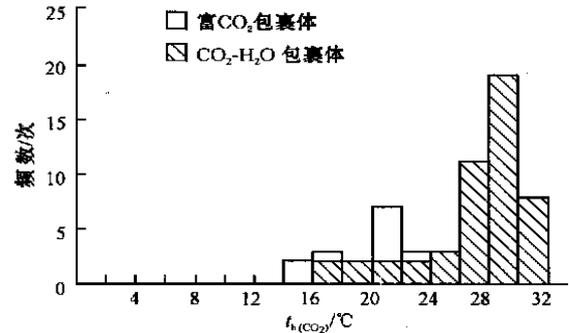
图 6 双王金矿床流体包裹体 CO<sub>2</sub> 部分均一温度直方图
