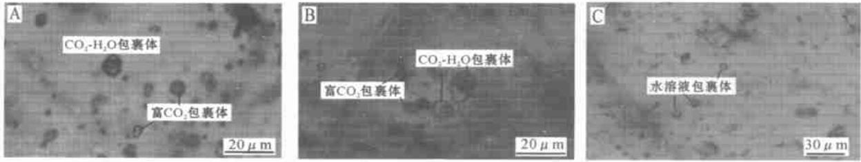
图4 铁白云石中的流体包裹体显微照片
