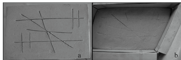
图 4 平面断裂系统力学性质实验图解(实验一结果图示)
