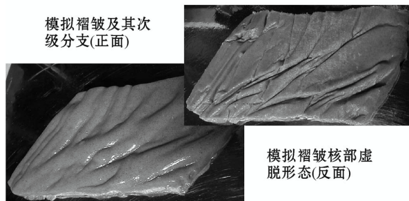
图 8 背斜核部虚脱部位形成的北东向导流网络图(实验三结果图示)
