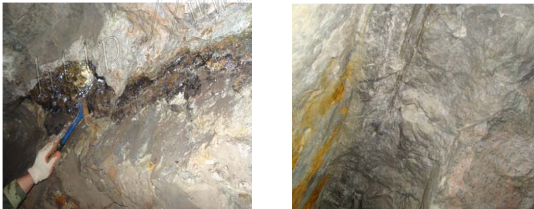
图4 在石英正长岩脉的上下盘发育的金属硫化物
