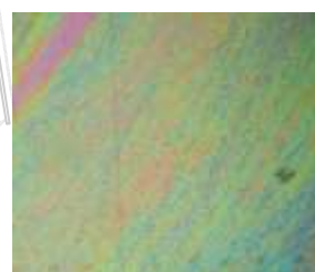
图2 碧玉的纤维状变晶结构 x40(+)
