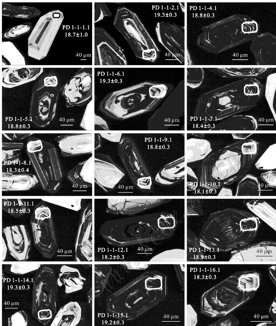
图 4 弄如日金矿二长花岗斑岩中锆石的阴极发光 (CL) 图像及测试位置(样品 PD 1-1)
