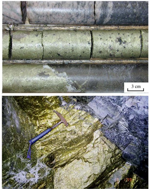
图 3 加拿大萨德伯里镍-铜-铂族元素矿床代表性钻孔岩芯和矿脉露头 (引自 Lightfoot, 2012 个人通讯资料)
