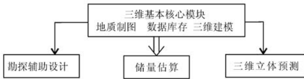
图 2 Minexplorer 软件功能框架图(肖克炎等,2010)
