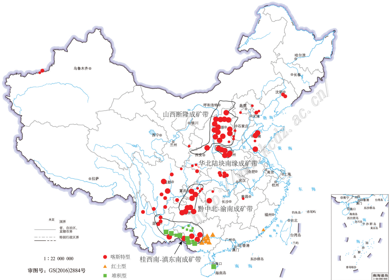
图 2 中国铝土矿矿床空间分布规律及 4 个重点成矿区带(底图据中国测绘协会网站 http://www.csgpc.org/list.php?fid=254 ) 符号大小代表矿床规模
